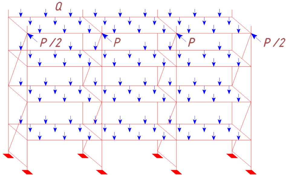
Рисунок 8 – Испытание на воздействие вертикальной нагрузки
