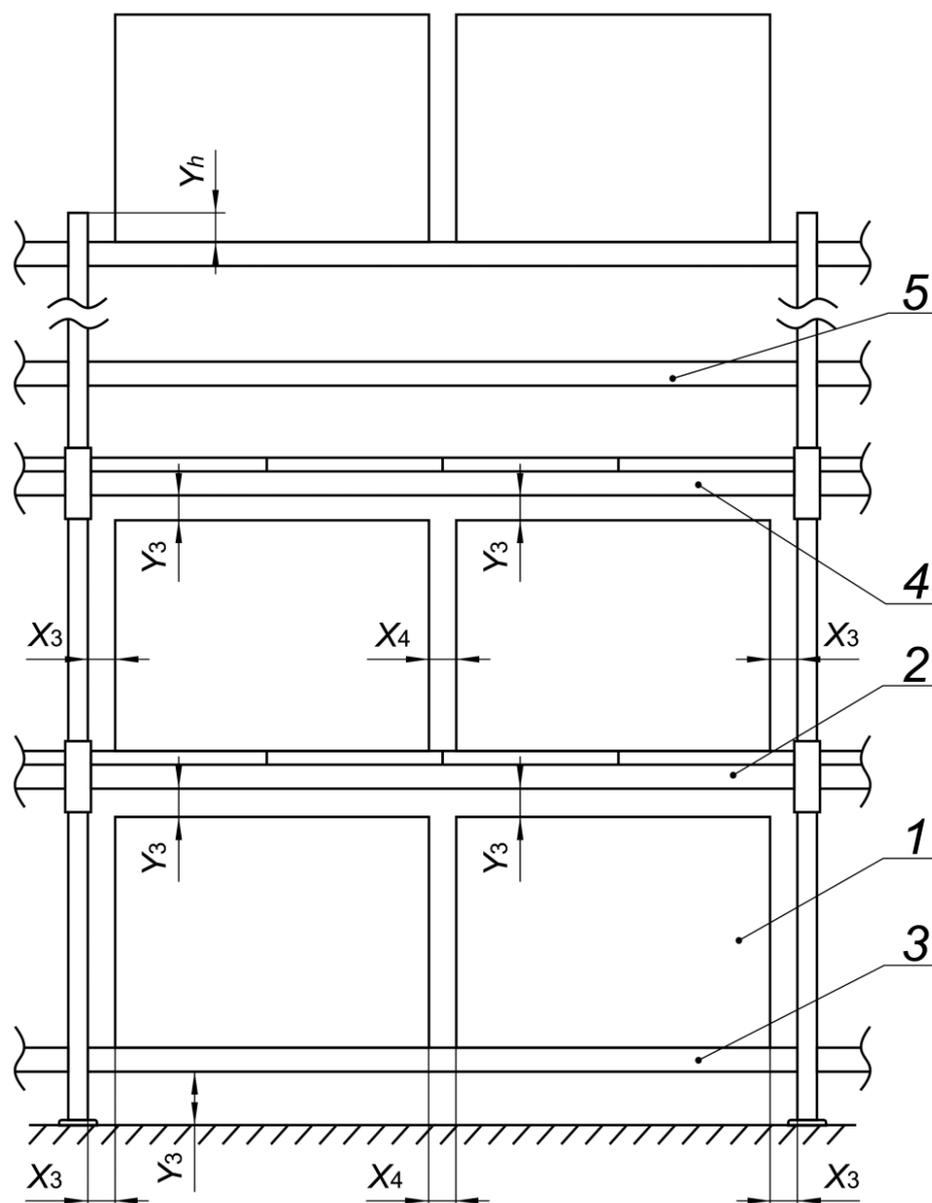
1 – груз; 2 – полка; 3 – балка с полками; 4 – балка с полками без прогиба (ненагруженная балка с полками); 5 – полка без прогиба (ненагруженная полка);  $X_3 \geq 20$  мм – рекомендуемое расстояние от груза до стойки стеллажа в направлении  $X$ ;  $X_4 \geq 20$  мм – рекомендуемое расстояние между грузами;  $Y_3 \geq 20$  мм – рекомендуемое расстояние от верхней плоскости груза до нижней плоскости полки следующего уровня хранения;
