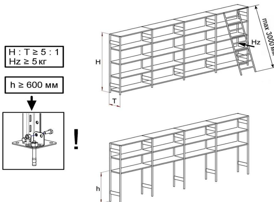
Рисунок 11 – Требования по креплению стеллажа к полу
